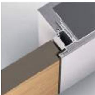
Für das System **TCS 45** ist das Türblatt ins Lichte gefälzt und öffnet sich revers. Das Türblatt ist 45 mm stark und mit einer VSP-Mittellage sowie optional mit einem Stabilisator ausgestattet. Die maximalen Nennmaße betragen 1110 mm in der Breite und 2500 mm in der Höhe. Das Türblatt ist erhältlich in Lebolit-CPL und Furnieroberflächen sowie Weiß- und Farblackierungen. Die Kantenausführung bieten wir in eckig an. Hierzu empfehlen wir einen Türöffnungsbegrenzer.
