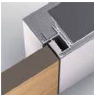
Für das System **TCT** ist das Türblatt stumpf und öffnet sich nach innen. Das Türblatt ist 45 mm stark und mit einer VSP-Mittellage sowie optional mit einem Stabilisator ausgestattet. Die maximalen Nennmaße betragen 1110 mm in der Breite und 2500 mm in der Höhe. Das Türblatt ist erhältlich in Lebolit-CPL und Furnieroberflächen sowie Weiß- und Farblackierungen. Die Kantenausführung bieten wir in ungefälzt / stumpf an.
